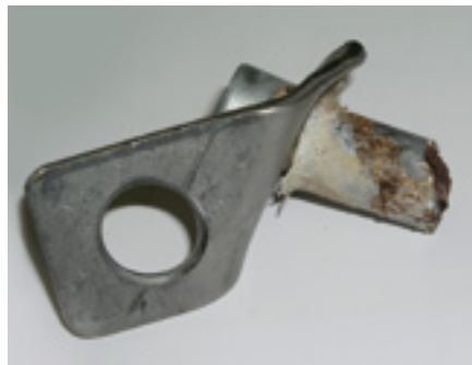
Korrosion im Dübelhohlraum zwischen Schraube und Spreizkegel führte zum Bruch des Systems bei einem normalen Sportklettersturz. Von außen war dem Haken nichts anzusehen.
