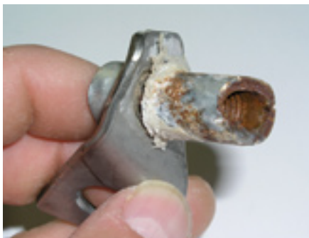
Korrosion im Dübelhohlraum zwischen Schraube und Spreizkegel führte zum Bruch des Systems bei einem normalen Sportklettersturz. Von außen war dem Haken nichts anzusehen.
