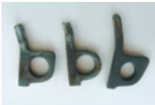
Sticht-Bohrhaken aus den 1950-er und 1960-er Jahren
