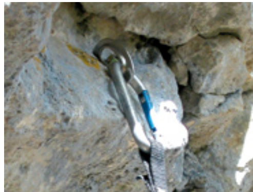
Biegebelastung bei einem schlecht platzierten Bohrhaken
