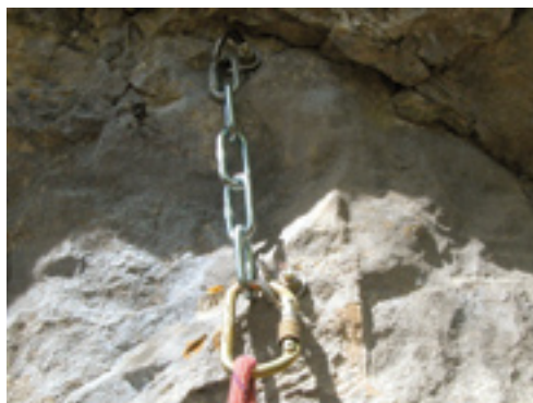
Zwei Expressanker mit Kettenschraubgliedern oder eine Kette abgehängt ermöglichen ein sicheres Umlenken.
