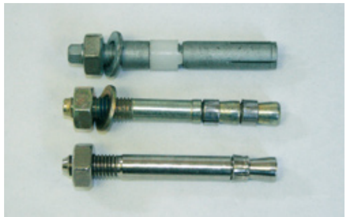
oben verzinkt, mitte gelbchromatiert, unten Edelstahl
